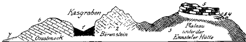
Fig. 6a. 1 = Werfener Schichten mit vielen Schollen. 2 = Ramsa dolomit. 3 = Ramsa dolomit, mylonitisch. 4 = Raibler Schichten. 5 = Dünnsschichtige, bituminöse Kalklagen. 6 = Tonschiefer und Sandsteine. 7 = Dunkle, bituminöse Dolomithbreccie. 8 = Dachsteinkalk. 9 = Hauptdolomit. 10 = Schutthang.
