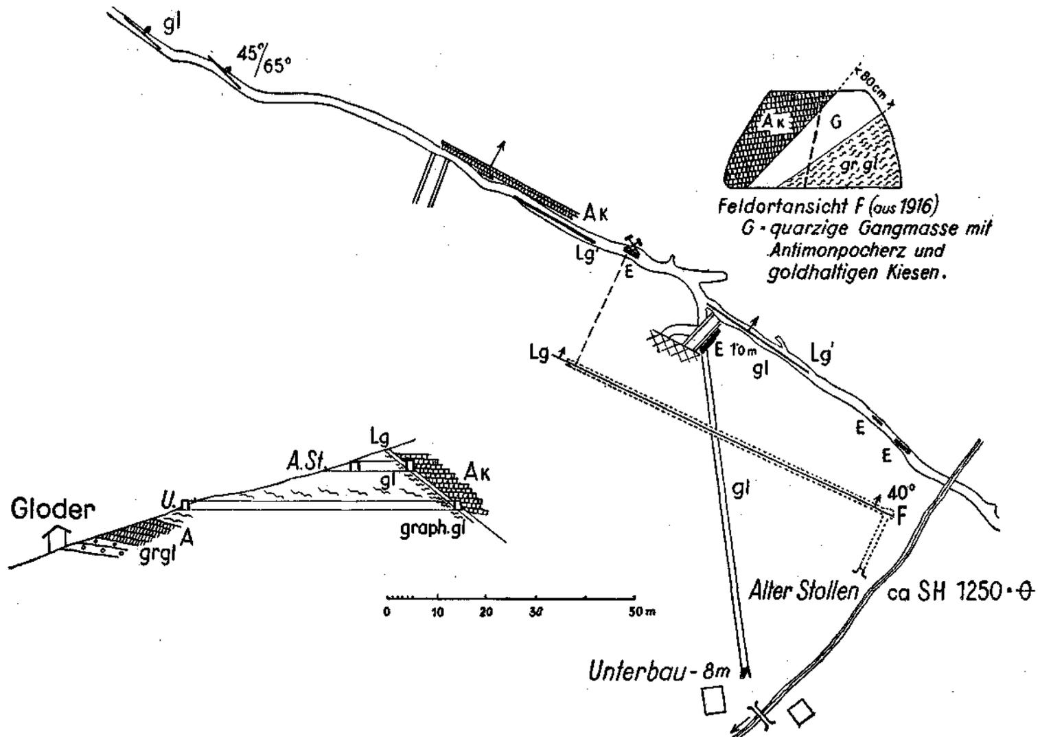
Abb. 10. Skizze zu den Lagerungsverhältnissen der Gurserkammerstollen am Zwickenberg bei Oberdrauburg.
