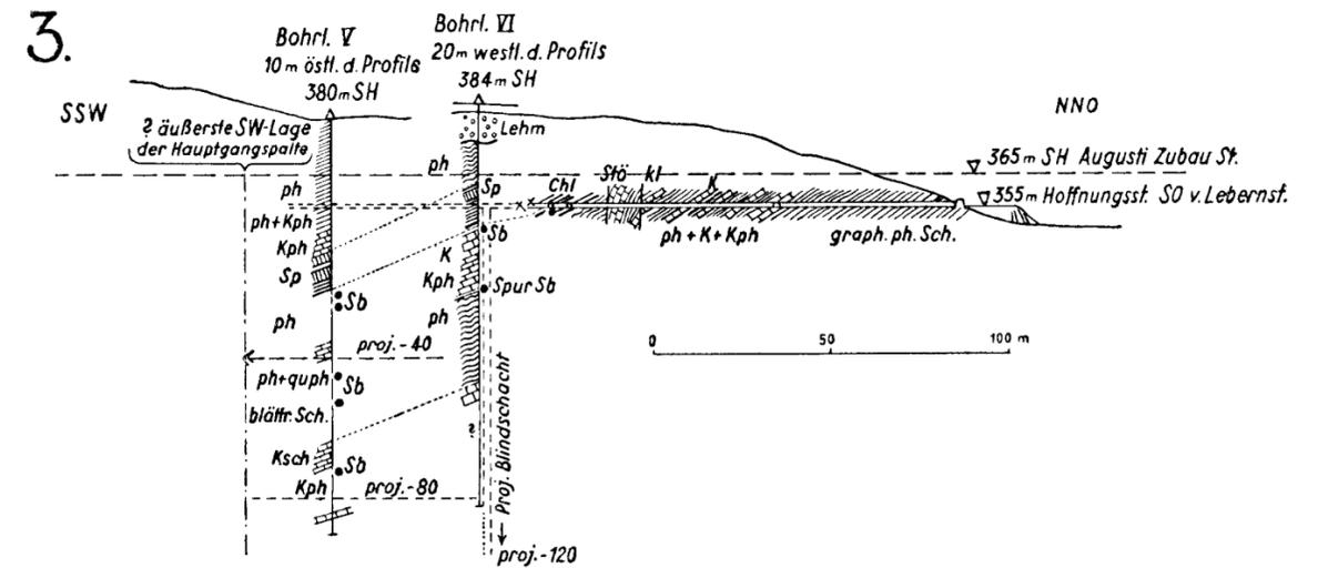
3. Geologisches Querprofil durch den Hoffnungs-Stollen zwischen Kurtgrube und Neustiftgrube, Schlaining.
