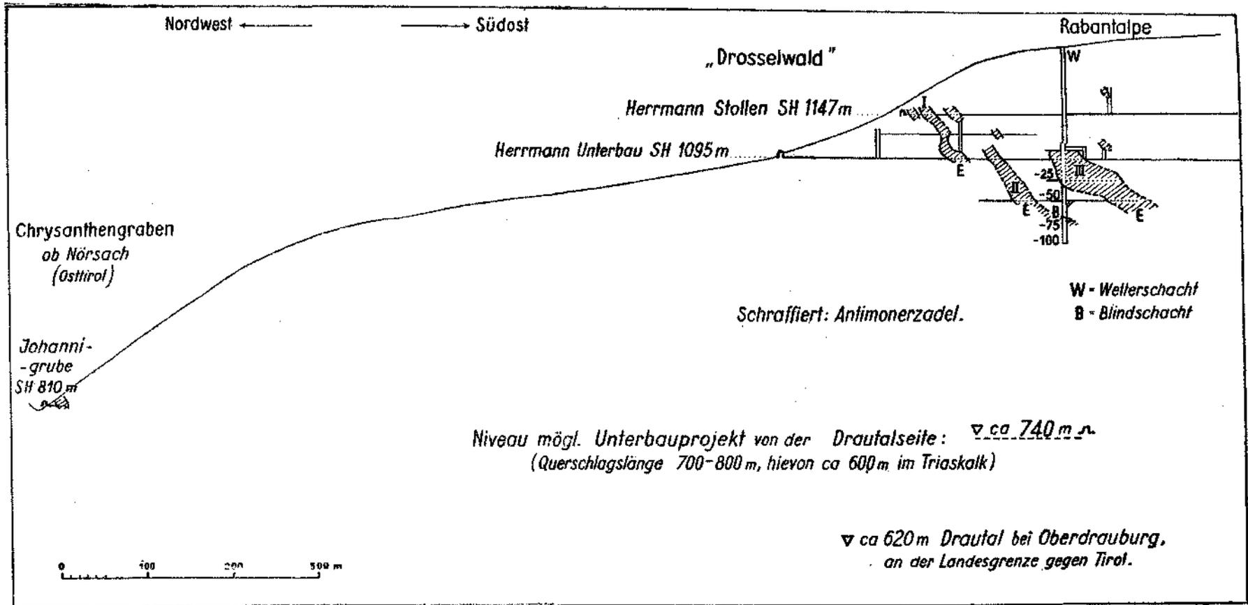
Abb. 15. Bergbau Rabant: Flachriß im Gangverflächen mit Adelszonen E (Aufschlußstand anfangs 1948).
