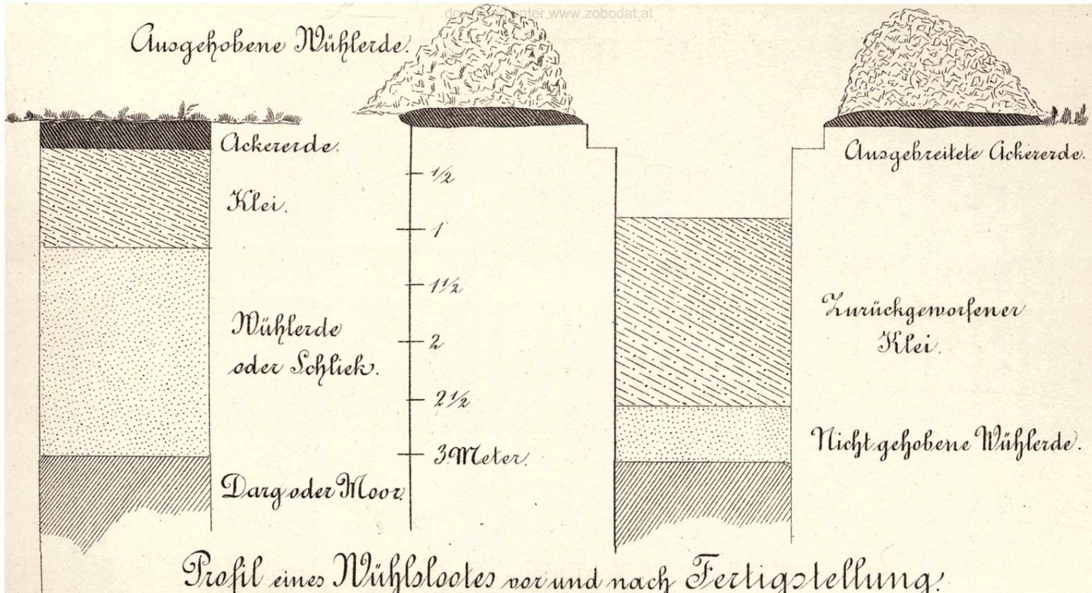
Profil eines Mühllootes vor und nach Fertigstellung.
