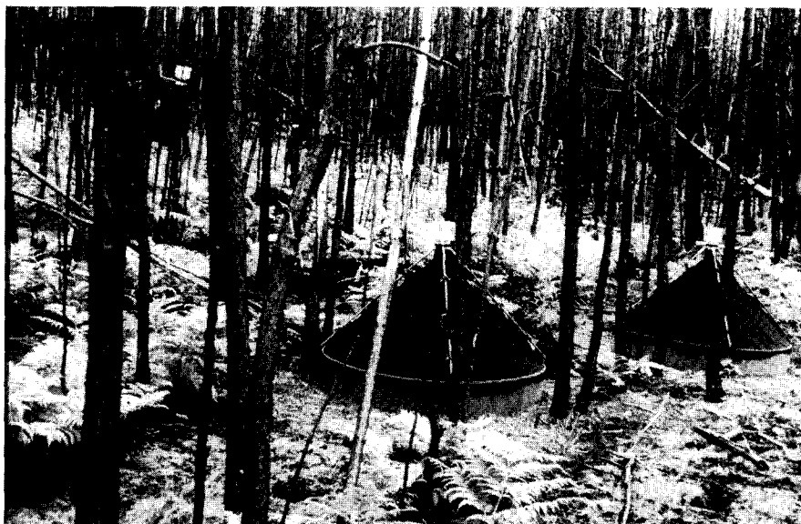
Abb. 2: Boden-Photoelektoren (Grundfläche 1 m 2 ) in 20jährigen verbrannten Kiefernkulturen der Lüneburger Heide 1976. Zustand ein Jahr nach Feuereinwirkung. Je ein Gerät ist in Pflanzreihe und im Zwischenstreifen in den Mineralboden eingelassen.
