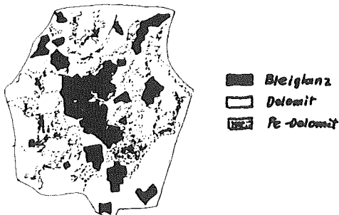
Abb. 2: Anschliffbild eines Handstückes aus der Dolomit-Breccie mit Bleiglanz.
