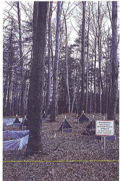
Abb. 2: Boden-Photoelektor im Rotbuchenbestand. Foto: Burgholz-Team
