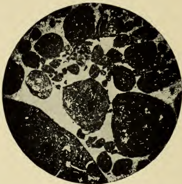
Fig. 4. Pseudoolithe aus dem Rugulosa -Kalk von Ehingen. (Der helle Teil ist grobkristalliner Calcit.)
