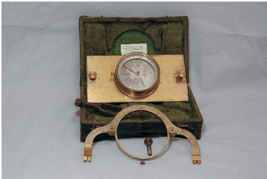
Hängekompass für Stollenvermessungen (LMJ/Abt. Geologie & Paläontologie, Inv.Nr. 45.680). Compass for mining surveying (LMJ/Dept. Geology & Palaeontology, Inv.No. 45.680).
