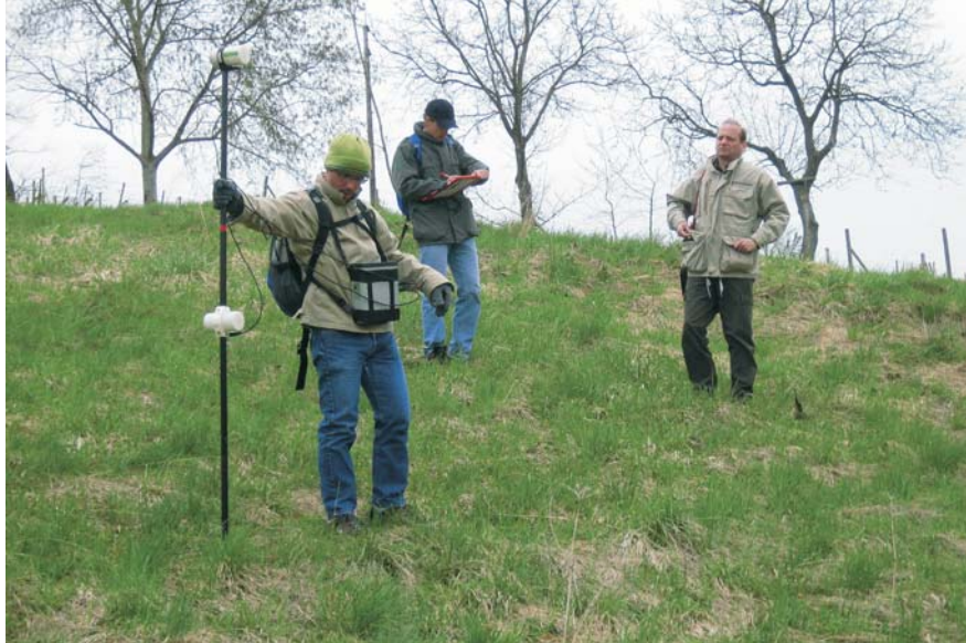
Geomagnetische Prospektion für Vulkanitvorkommen. Geomagnetic prospection for volcanic rocks.
