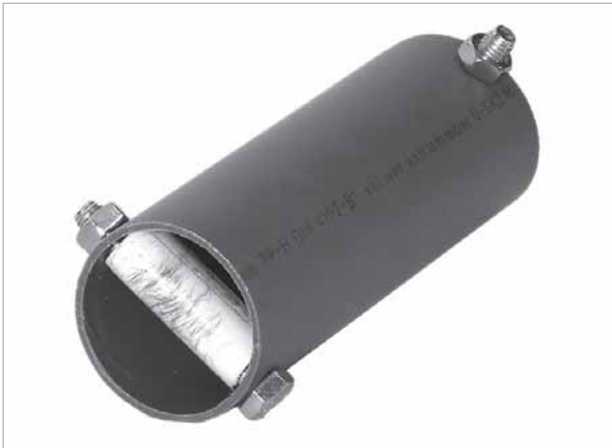
Abb. 3: Haarhaftröhre mit positiver Probe. Foto: C. Blatt & S. Resch.
