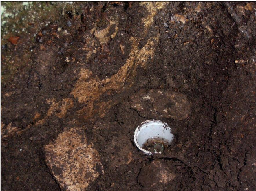
Abb. 2: Tiefbodenfalle im Einsatz; am linken oberen Bildrand liegt das Niveau der Bodenoberfläche. Foto: M. Egger.
