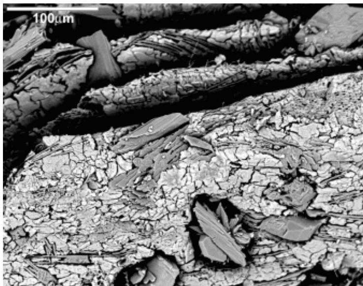
Abb. 5: Detail aus Abb. 4. Deutlich sind die beiden, im Grauwert unterschiedlichen Phasen zu erkennen: Newberyit (dunkelgrau) und das Kalium-Analogon von Struvit (hellgrau) vom Wetterschacht, Rossblei-Revier, Schladminger Tauern.
