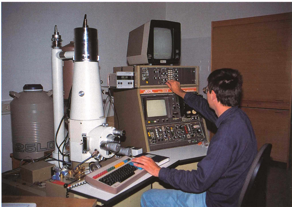
Mag. H.-P. Bojar am neu installierten Rasterelektronenmikroskop des Joanneums. Foto: W. Postl.
