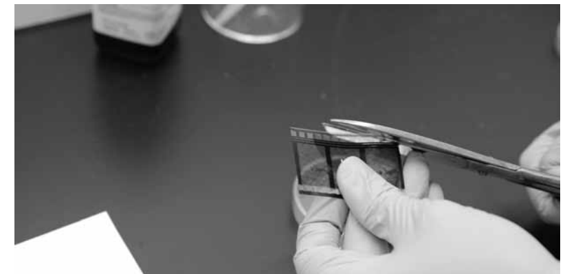
Probenentnahme an einem 35mm Film für den Diphenylamintest zum Nachweis von Nitrocellulose, Foto: Fenna Yola Tykwer
