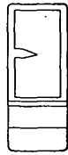
Abb. 8. Das kleinere der ausgestanzten Plättchen mit ausgeschnittenem Mittelbalken zur Präparation von Minuten. — Zweimal vergrößert.
