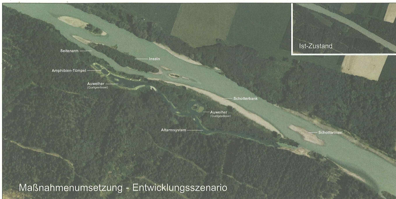
Abb. 2: Flussaufweitung Drau bei Rosenheim (Vorher – Nachher Vergleich in einer Fotomontage): Viel Hirnschmalz wurde investiert, um flussmorphologische, schutzwassertechnische und naturschutzfachliche Zielsetzungen optimal aufeinander abzustimmen.
