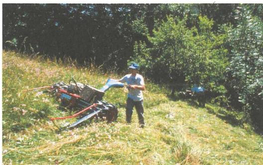
Abb. 6: Mahd der Steilhangflächen mit handgeführtem Bergmäher
