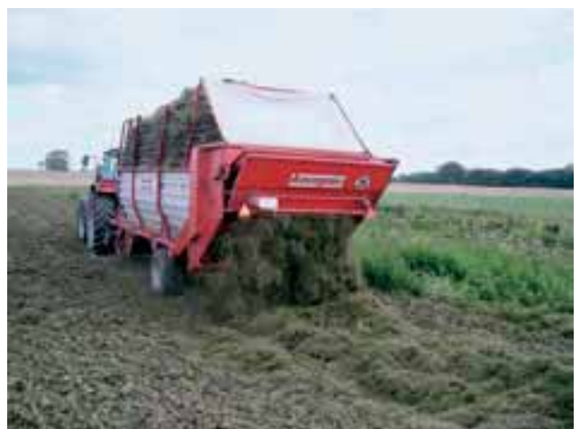
Abbildung 2: Mahdgutverteilung auf einer Renaturierungsfläche mit einem Siloladewagen (Photo: Matthias Harnisch, Riedstadt)
