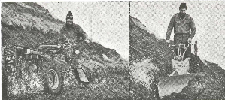
Abb.11 Lockern und grobes Ausplanieren mit Motorfräse
