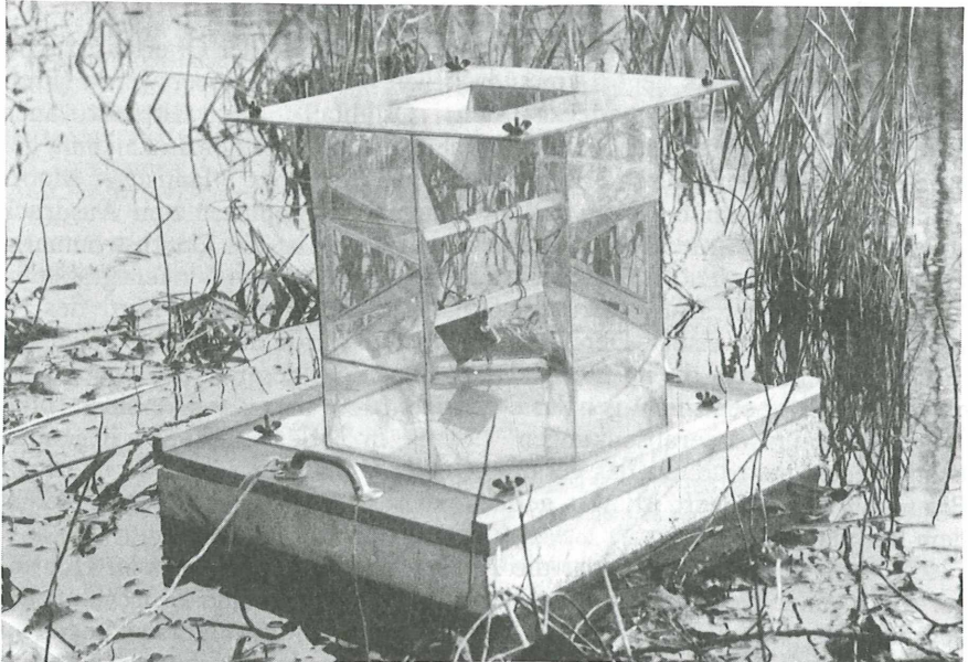
Abb. 1: schwimmfähige, batteriebetriebene Lichtfalle
