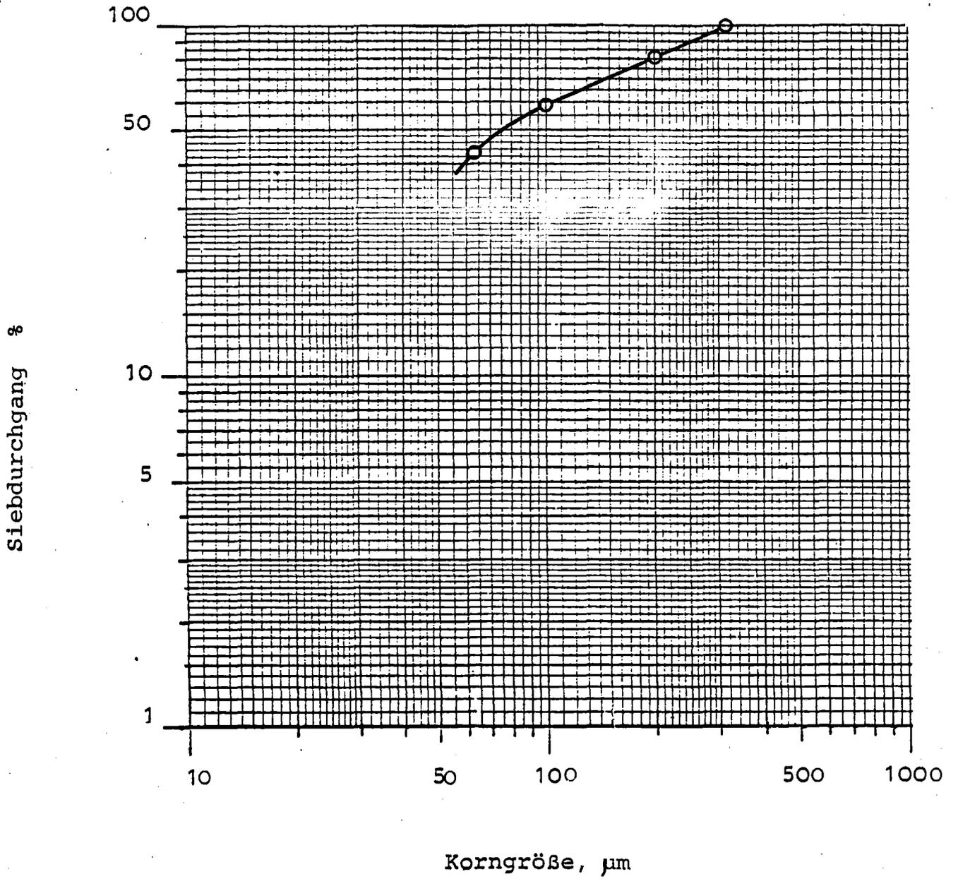
Siebanalyse des Stabmühlenerkleinerungs-
