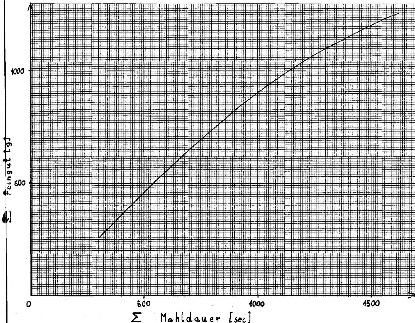
Graphische Darstellung der Feingutbildung in Abhängigkeit von der Mahldauer bei der Zyklenmahlung des Vorlaufes der Laugung (Mahlung <math><200 \mu\text{m}</math>)
