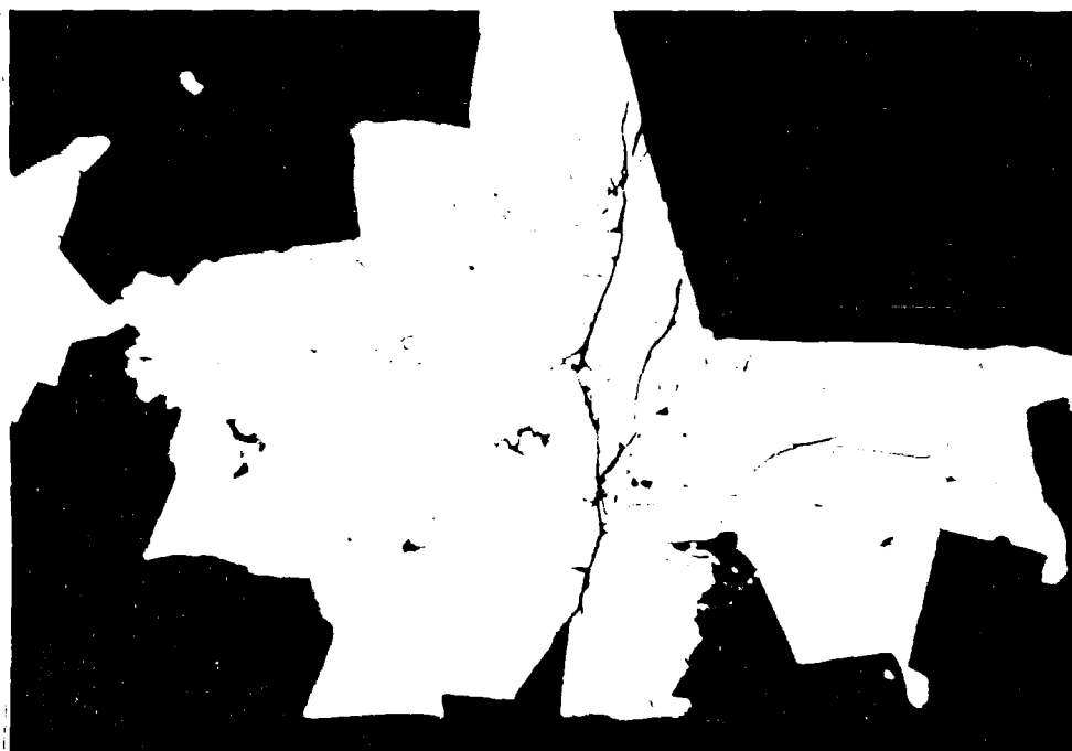
Abb. 25: Probe 405, // Nic., Bildbreite \hat{=} 0,95 mm Großer, lappiger Körper von Tennantit mit Kataklastenstruktur. Schwarz: Karbonat
