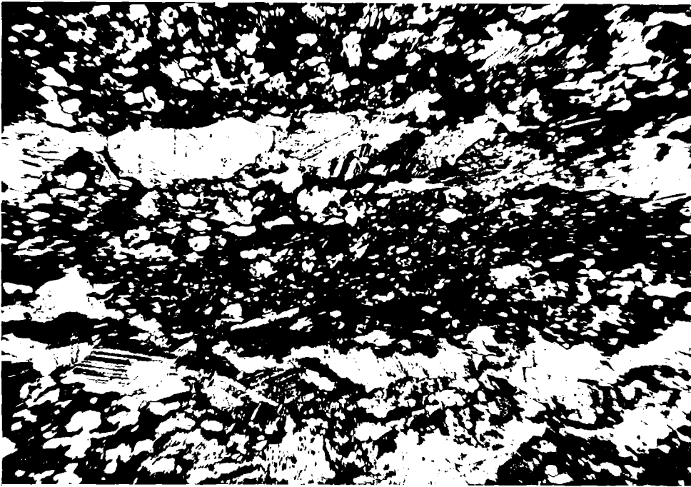
Abb. 38: Probe 466, + Nic., Bildbreite \hat{=} 2,3 mm "Metatuffit" mit epiklastischen Lagen von Calcit + Quarz. Diese wechsellagern mit feinkörnigem Chlorit, Albit, Epidot/Klinzoisit und + Quarz (pyroklastischer Anteil). Als Grund für diese Wechsellagerung wird eine starke Tuffeinstreuung während der "normalen" Hintergrundsedi- mentation angenommen.
