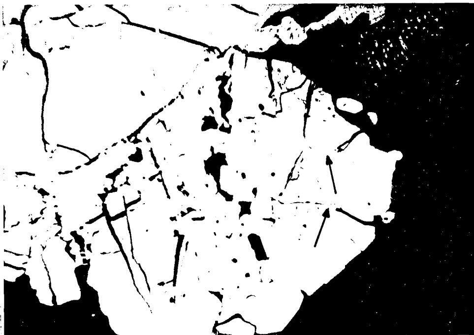
Abb. 31: Probe 510-C, // Nic., Ölimmersion, Bildbreite \hat{=} 0,2 mm Gold (weiß) in Kupferkies (mittelgrau) und Pyrit (hellgrau). Z.T. werden feine Risse im Pyrit verkittet (Pfeile). Dunkelgrau/schwarz: Gangart
