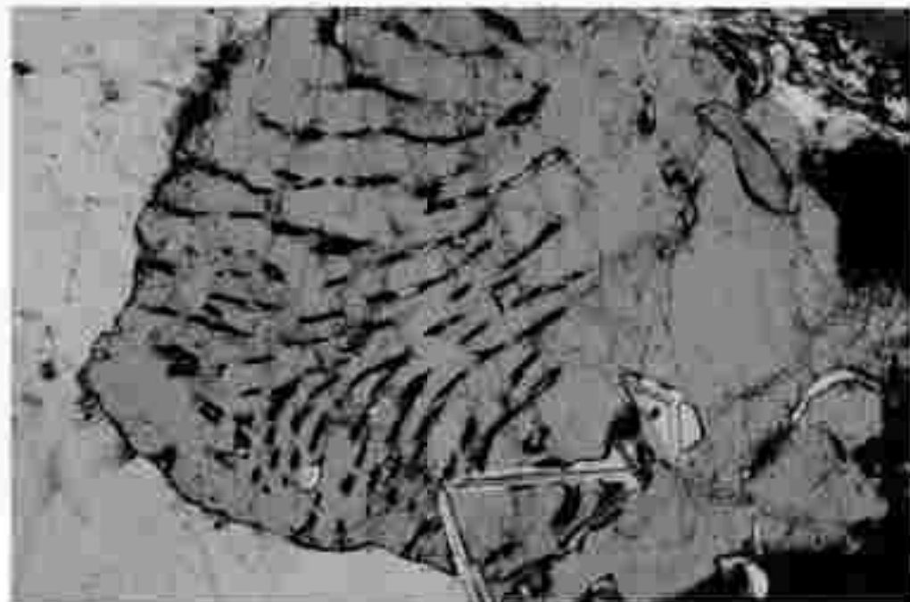
Abb.26: Pegmatoid Obersteirung - Gföllgraben (Dünnschliffauschnitt, Bildgröße ca. 1,3 mm, Nicola 90°) Myrmekitbildung am Rand eines Alkalifeldspates.
