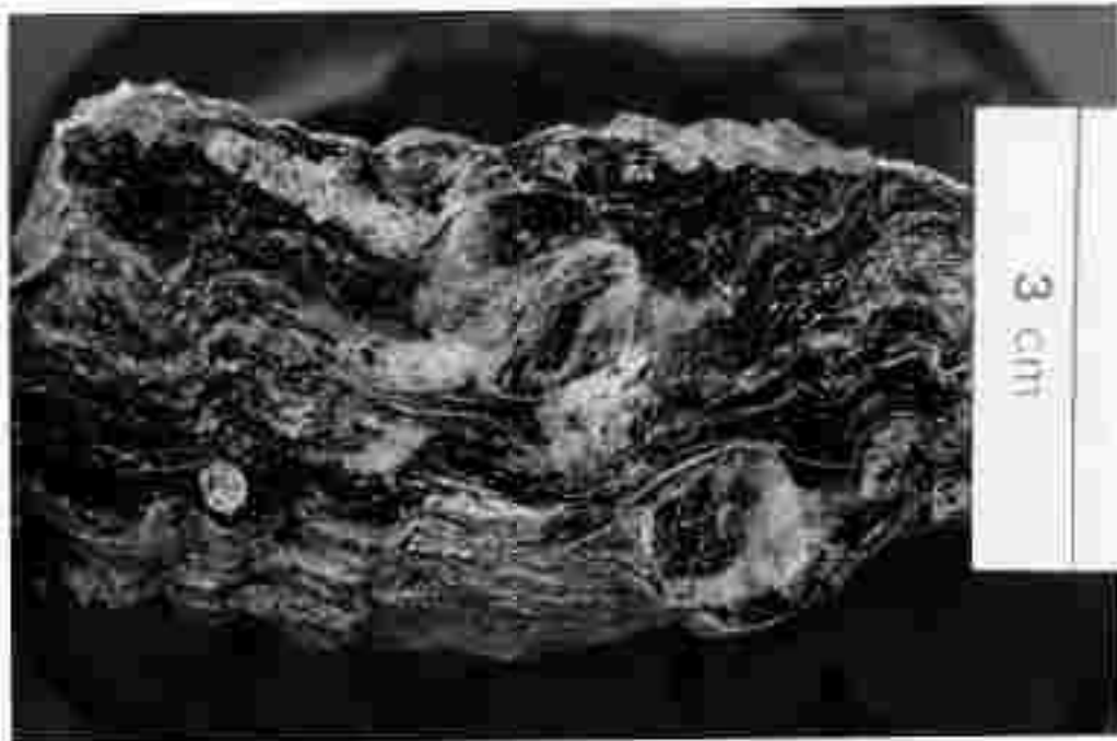
Abb.36: Anschließ eines Granatglimmerschiefers, Granate z.T. zerbrochen und diaphthoritisch umgewandelt; Weg zum Schmelzotoder
