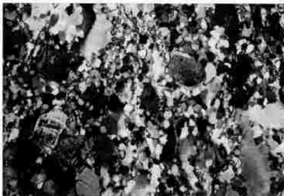
Abb.5: Quarzit (Sulzbachgraben, östliche Flanke, Güterweg 1160 m), Dünnschliffausschnitt: Feldspatblästen in feinkörniger Quarzmatrix. Serizit deutet eine Schieferung an. Nicola +, wahre Bildlänge: 3,4 mm.
