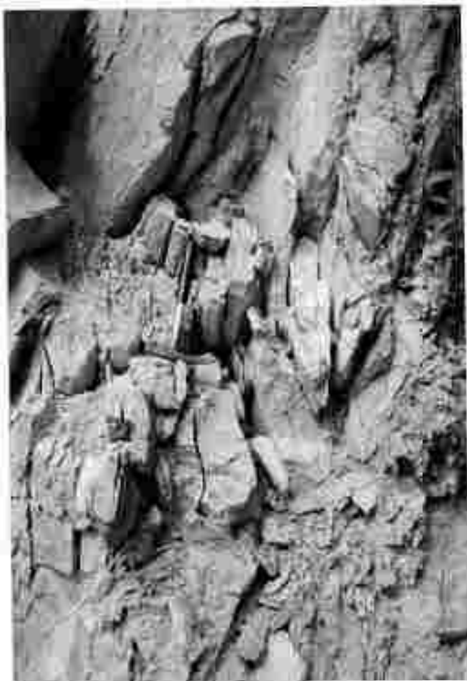
Abb.7: Flitzenschlucht W-Seite, Güterweg 950 m; steilstehender plättiger Quarzit, kleinstückiges Bruchverhalten
