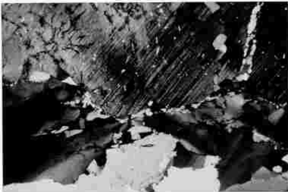
Abb 23: Pegmatoid südlich Bretsteingessen (Dünnschliffanschnitt, Bildlänge ca. 3,4 mm, Nicol 90°) Die obere Bildhälfte zeigt einen Teil eines Plagioklasblaitum mit spärlicher Serizitführung, darunter undulös auslöschender Quarz.
