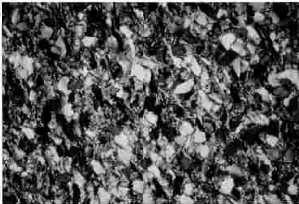
Abb.19: Quarzit (neuer Güterweg auf den Hirkeienkogel, 1190 m), Dünnschliffanschnitt: Sedimentstruktur teilweise erhalten, Quarzkörner durch Serizit getrennt, Nicol +, wahre Bildlänge 3,4 mm.
