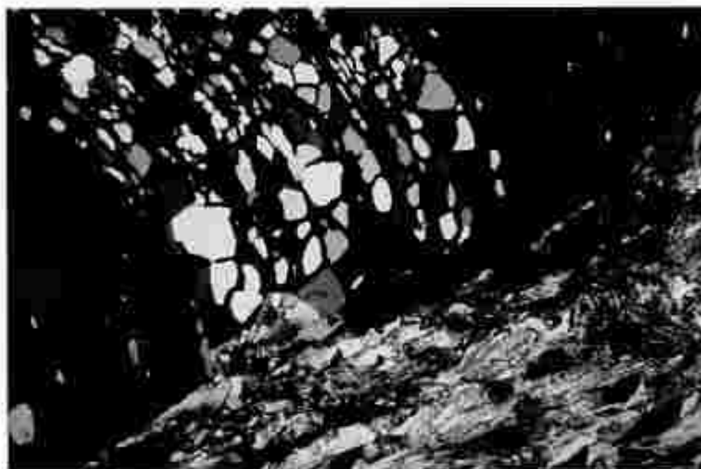
Abb.32: Teile des Granats sind skelettartig erhalten, Quarz ist in den Hohlräumen eingeschlossen, Fundpunkt (wie Abb.31) Nicols +, wahre Bildlänge 3,4 mm.
