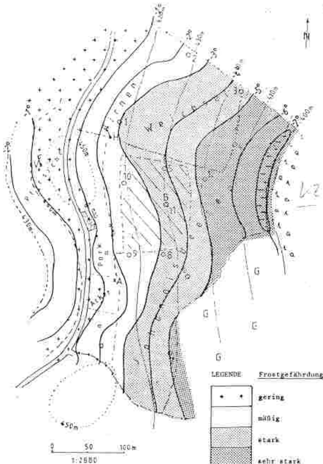
Abb. 5: Temperaturverteilung zum Zeitpunkt des Minimums (gegen 6h) am 10.4.81; Meßhöhe 1 m über Grund; zu beachten ist die Temperaturniedrigung infolge Kaltluftstau am Wald (Ziffern bedeuten Meßpunkte - Minimumthermometer).
