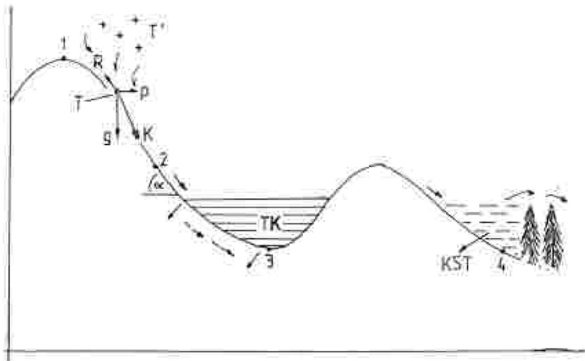
Abb. 1: Kaltluftabfluß schematisch (modifiziert nach W. Endlicher, 1980).
