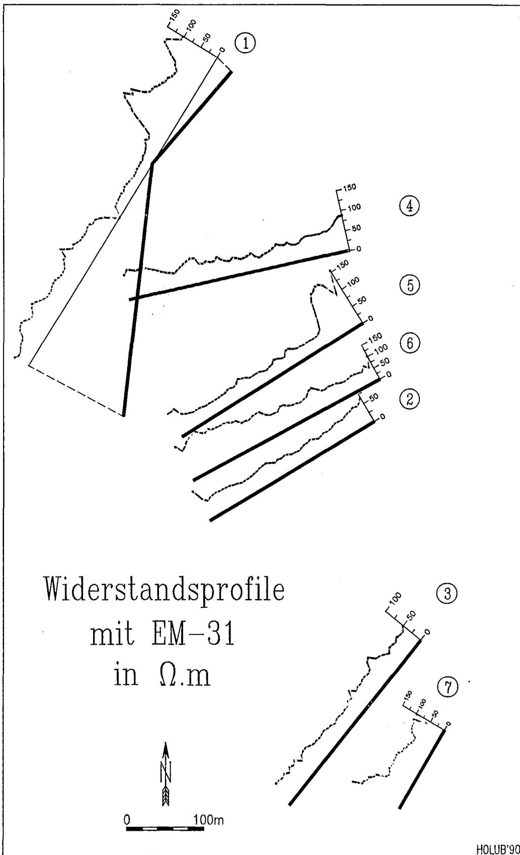
©Literaturarchiv Beilage 10 Verteilungskarte des spezif. elektr. Widerstandes aus der elektromagnetischen Kartierung mit Lage der Meßprofile und Bergbauhalden. Geologische Grenzen nach KOLLMANN (1964). Kartenausschnitt entspricht Meßgebiet in Beil. 4
