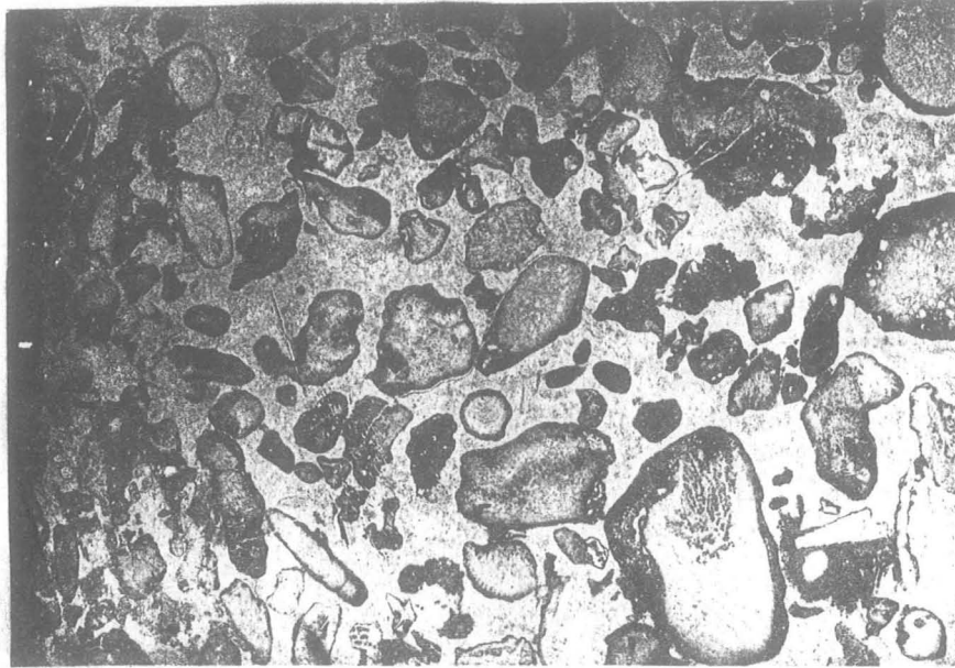
Abb. 1 "Plassen-Kalk" . Komponentenreicher "Riffschutt"-Kalk mit zahlreichen abgebrochenen und durch Algen umkrusteten Organismenresten (Korallen , Hydrozoen , Kalkalgen u.a.) in grob-spätiger (sparitischer) Grundmasse . - Schliff Krahstein 188 , Vergr. x 3,3 .
