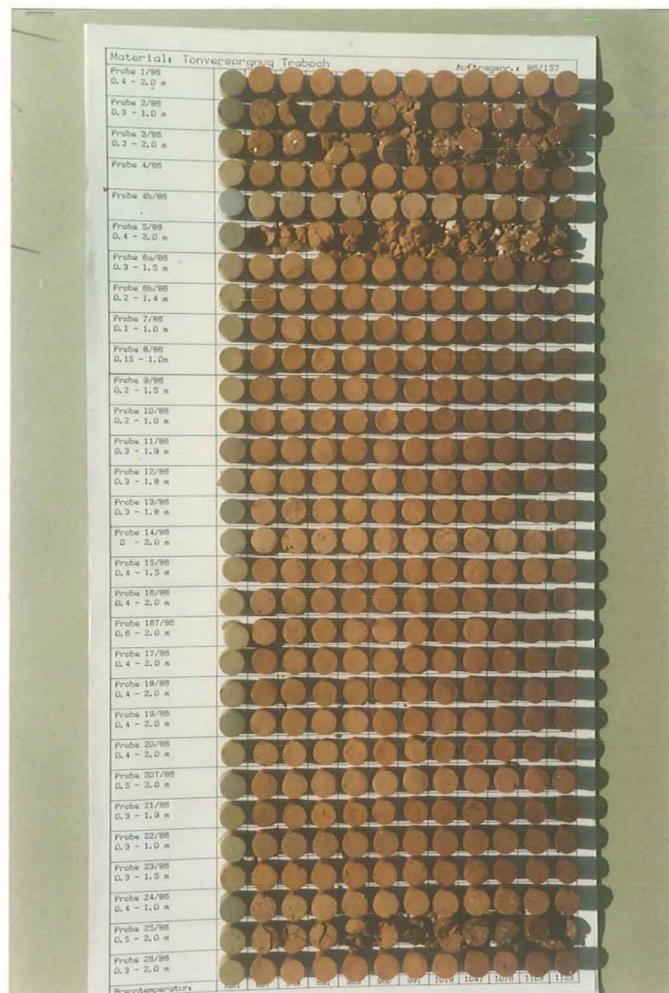
Abb.1: Tonproben nach dem Gradientenbrand
