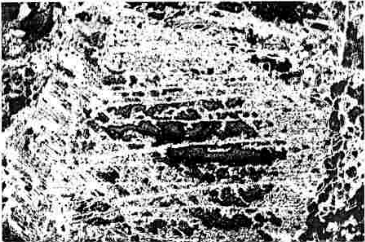
Brauneisenerz. Buchkogel bei Graz. Nafeliseisenerz (weiß bis hellgrau) verdrängt Ankerit (dunkelgrau bis schwarz), dring vor allem entlang der Spaltrisse des Karbonates vor und läßt dadurch die Entstehung des Limonites gut erkennen. Rechts Porenzüge nach ausgelaugtem Ankerit. (94 x)
