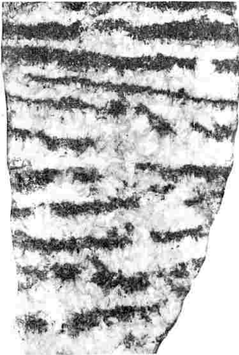
Bändermagnesit, angeschliffenes Stück; es soll zeigen Anhalten oder Auskeilen, auch Verdrehung der dunklen, feinkörnigen Bänder; gröberes Korn bei teilweise symmetrischer Gangstruktur in den hellen Bändern. Etwa doppelte Größe.
