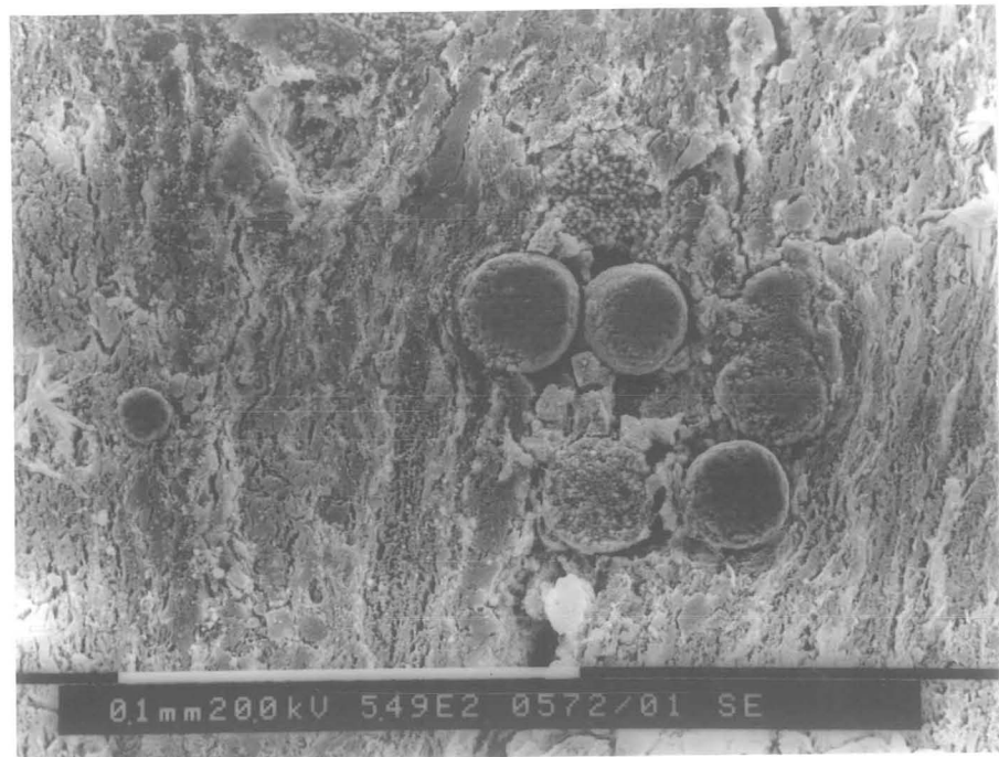
Abb. 4. Kugelige Aggregate von Pyrit in Kohle. Bohrung 1138, 46,4 m; Geätzt, Vergr. 1100 x.
