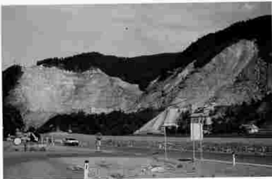
Abb. 21: St.Lorenzen, Preg; Serpentinsteinbruch, Hartsteinwerk Preg; sehr großer Steinbruch mit Etagenabbau.
