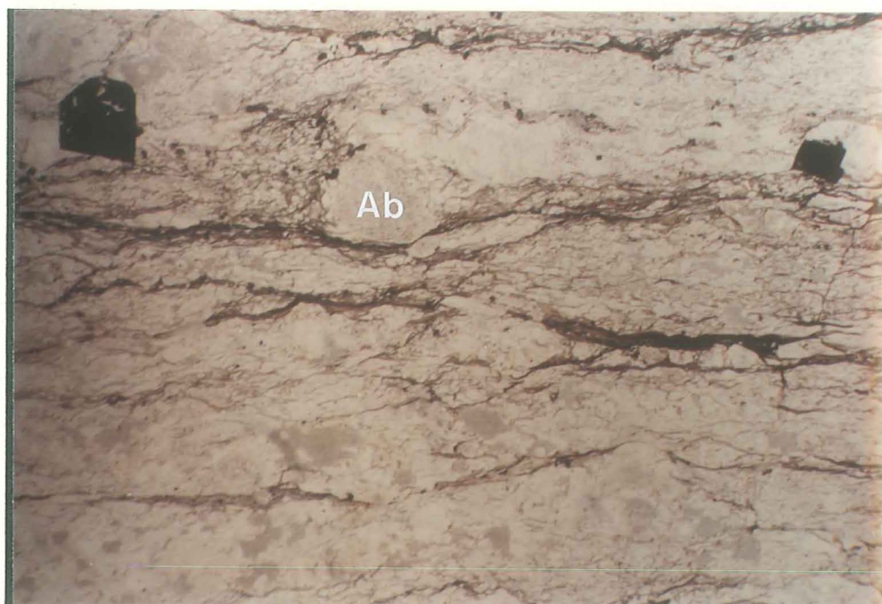
Abb. 7: P 19, erzführender, Feldspatschiefer, Vergr. ca. 12x, Nichols //.
