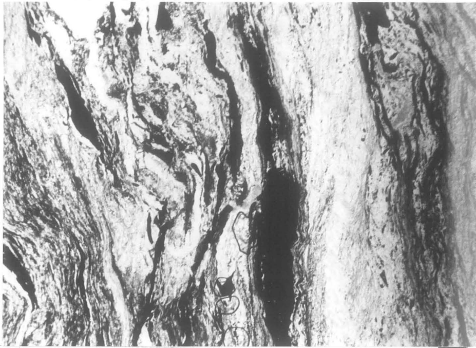
Abb. 3: P 11, Graphitphyllit, Vergr. ca. 12x, Nichols //. vgl. Abb. 2, repräsentativer Ausschnitt bezüglich der Graphitverteilung.
