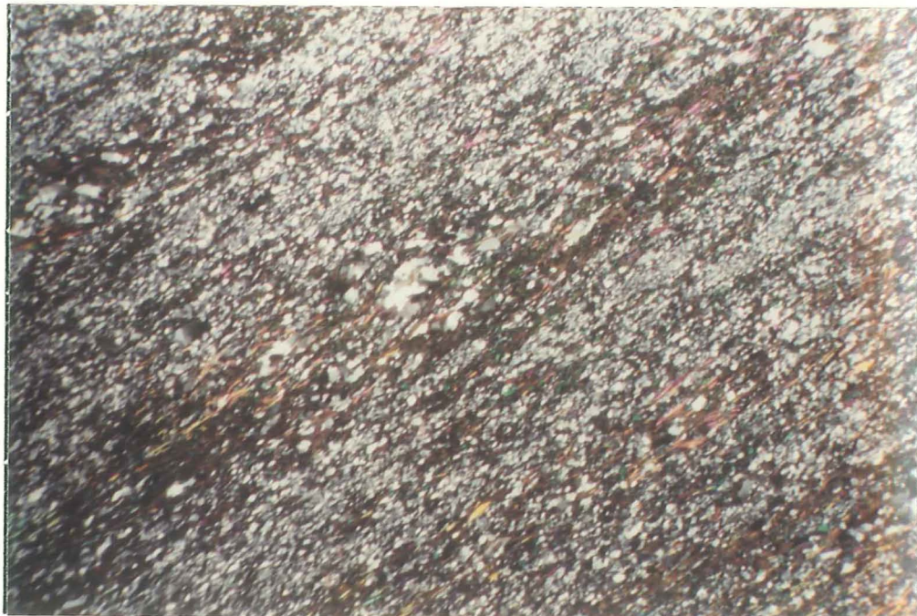
Abb. 20: P 28, Ep-Chl-Schiefer, Vergr. ca. 12x, Nichols +. Beachte Unterschied zu Abb. 18+19. Granoblastischer, kaum deformierter Mineralbestand. Deutliche Schieferung (Hgl, Chl, Ep-Schnüre danach eingeregelt).
