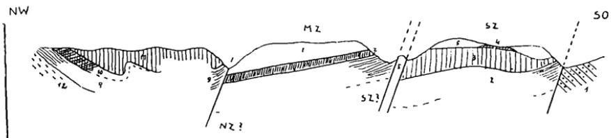
Abb. 5. Schematisches Profil durch die südliche, mittlere und nördliche Zone. 1. Verrucano (Sandstein, Breccie und Konglomerat). — SZ. Südliche Zone. 2. Werfener Schiefer, 3. Dolomit, 4. Schwarze Schiefer, 5. Wettersteinkalk. — MZ. Mittlere Zone. 6. Werfener Schiefer, 7. Serie der dunklen Kalke der Klaus, 8. Wettersteinkalk. — NZ. Nördliche Zone (Poľudnica-Decke). 9. Werfener Schiefer, 10. Guttensteiner Kalk, 11. Dolomit, 12. Karbon.
