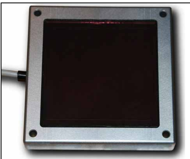
Abb. 9: Sensor eines für die Lichtmessungen verwendeten Lightmeters. Die Sensorfläche beträgt rund 50\text{ cm}^2 , woraus sich die hohe Lichtempfindlichkeit dieses Geräts ableitet.
