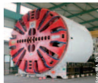
Die 136 m lange und 1.090 t schwere „Erddruckschildmaschine“ bei ihrer letzten Prüfung im Werk
