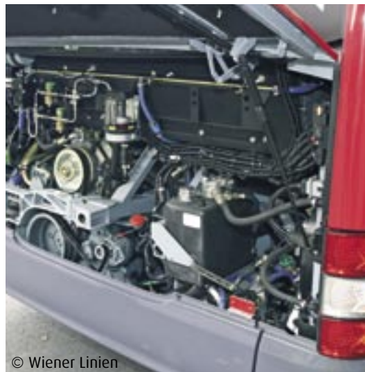
Der neue Flüssiggasmotor verbraucht um 14 % weniger Treibstoff
