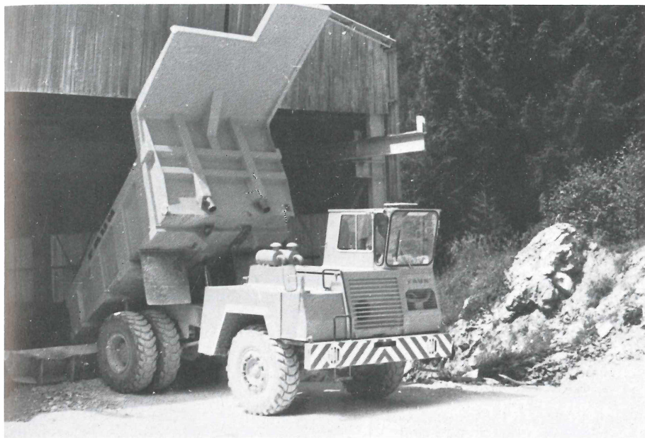
Abb. 84 Brecheranlage Gipssteinbruch Moosegg, Abkippen des Fördergutes in die Brecheranlage. (Moldan)
