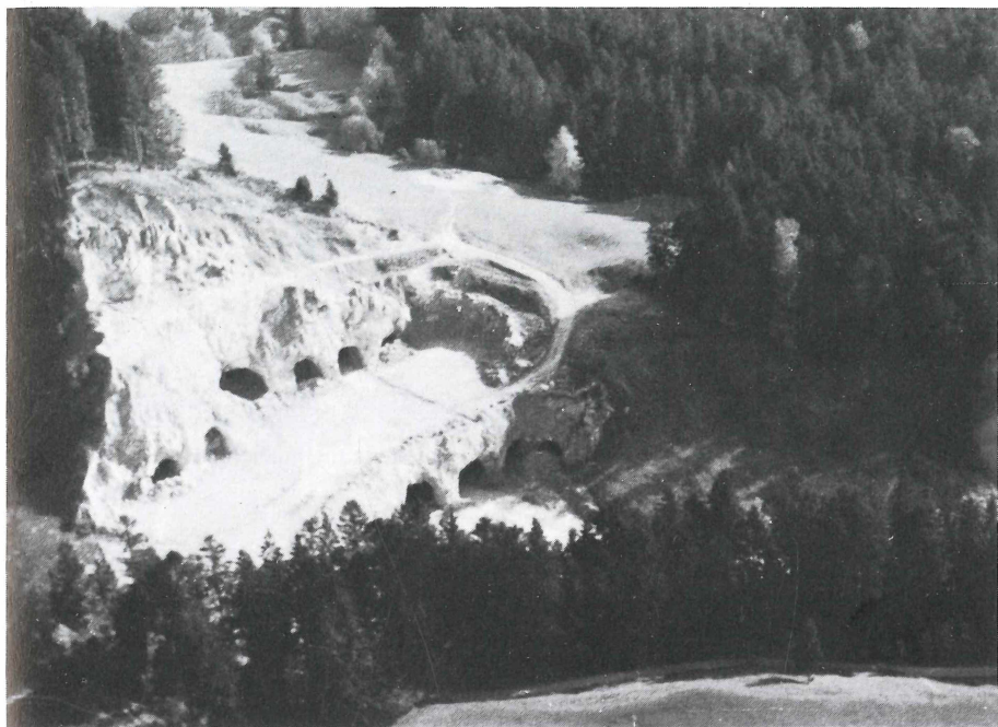
Abb. 134 Gipssteinbruch und Gipsbergbau Webing der Firma Moldan. Gesamtansicht, 3 Sohlen; oberste und 1. Sohle Tagbau, 2. und 3. Sohle Untertagbergbau, 1984. (Moldan)
