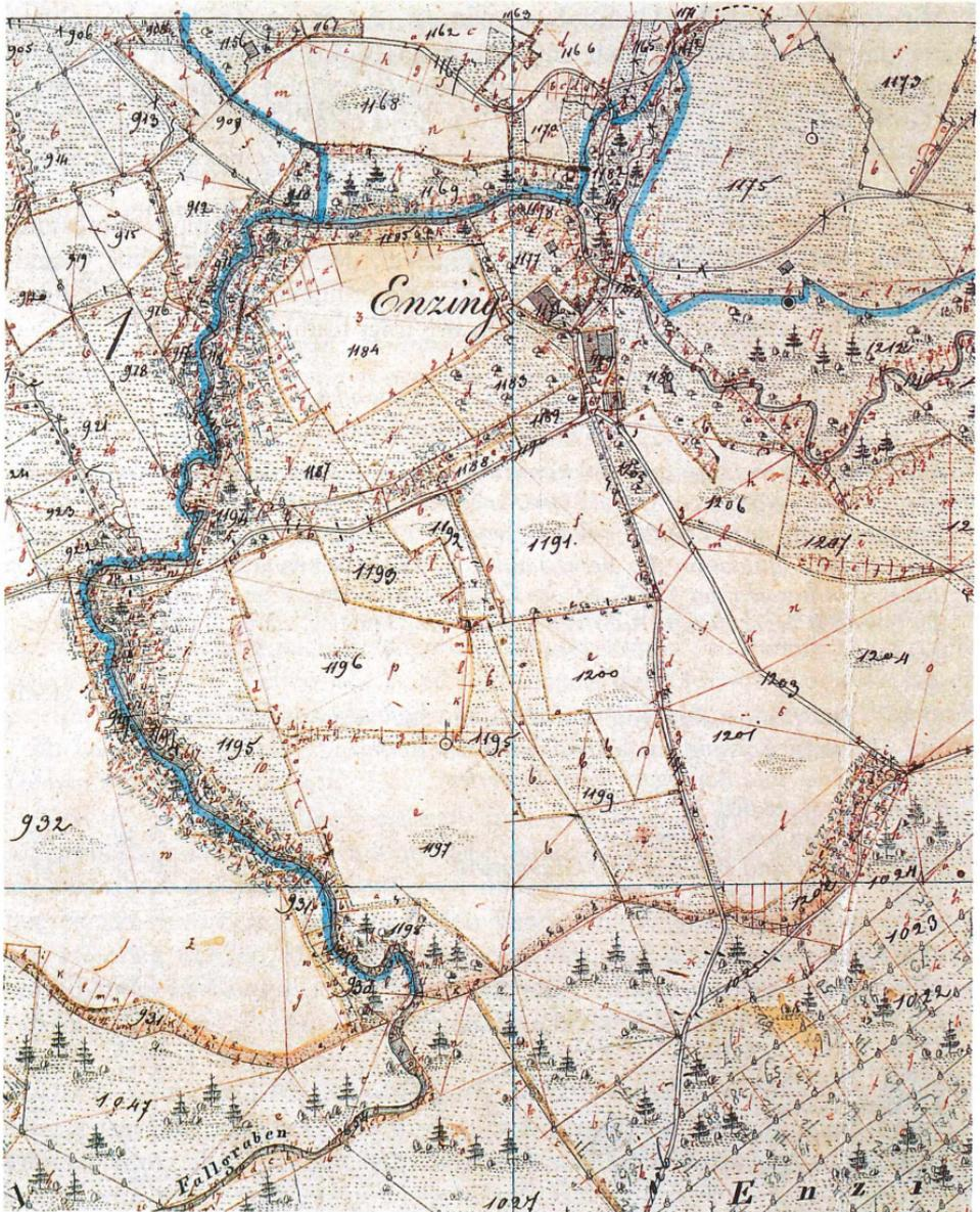
Abb. 16 Karte der Renovationsvermessung von 1854 mit heute noch gültigen Flurnummern. Die deutlich erkennbare Grundstücksunterteilung in Dreiecke diente der Flächenberechnung.
