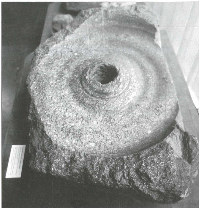
Abb. 9 Radhausberg/Hohe Tauern, Unterstein einer Mühle mit konzentrischen Ausschleifungen vom Feinmahlen des goldhaltigen Quarzes (Deutsches Bergbau-Museum Bochum, Inv. 36027).
