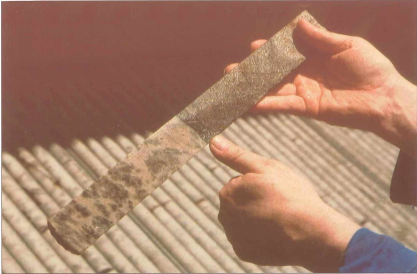
Abb. 10 Daumenstarkes Merenskyreef, Bohrkern; Impala Mine (Bushveld Massiv/Südafrika).
