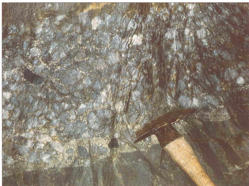
Abb. 5 Goldführende Konglomerate mit angerundeten Pyritkörnern in der Matrix der Konglomerate.
