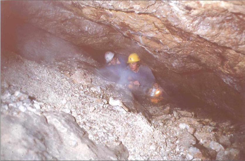
Abb. 2 Zeche an der Steinerklufft, Sohlbau des Kreuzstollens, Teilrevier Burgstall des Ringenwechsel, Bergbau Schwaz. Vererzung an einer „Kluft“ mit remobilisierten Fahlerzen; um 1500–1550 gebaut. Wegen des Fehlens seitlicher Imprägnationen oder Aufsitzer erfolgte kein späteres Nacharbeiten. Generell arme Vererzungen an alpidischen Scherflächen.
