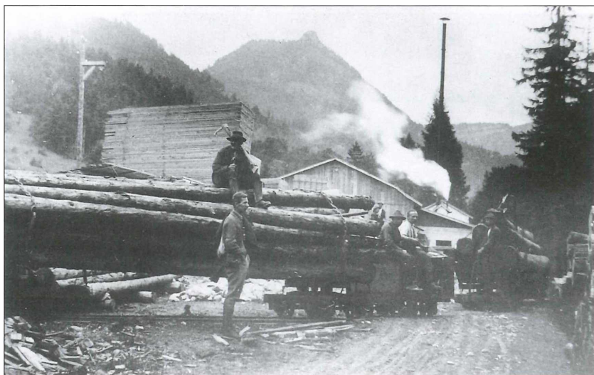
Mit Langholz voll beladener Waldbahnzug am Hundsleitenlagerplatz (um 1935), mit der alten 4 PS Puch-Benzinlokomotive und mit alten Trucks. Dahinter ist das Sägewerk der Fa. Schwarz zu erkennen, das Ende der 1930er Jahre abgebrannt ist. Im Bild stehend Obfö. Alois Kals, der von 1925 bis 1949 für den Waldbahnbetrieb zuständig war; in der Lok: Franz Sams sen. (Fotoquelle: DI Rüdiger Bruckmoser jun.)
