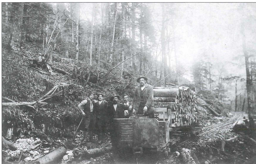
Waldbahn um 1923. — Der Holzakkordant Simon Hödlmoser vulgo Matzinger steht in der 4 PS Puch-Benzinlok (Fotoquelle: A. Strubreiter).
