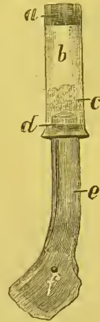
c Kalbszahn. b Glasrohr, bei d mit Wachs befestigt. e Watte. a Wachsverschluss. f Künstliches Foramen.
