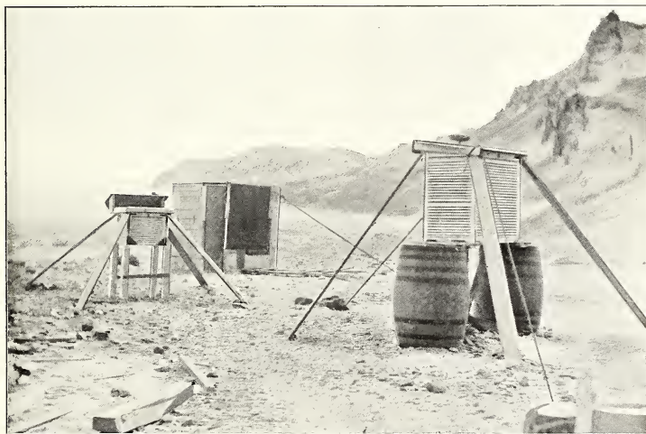
Das kleine Thermometergehäuse mit der geschützten Abdunstungsschale, das astronomische Observatorium und das grosse Thermometergehäuse mit der freien Abdunstungsschale.
