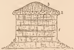
Fig. 82. Säulenförmig zerklüftete, horizontal abgelagerte pliocene Thonschichten. Durchschnitt einer säulenförmigen Partie.
