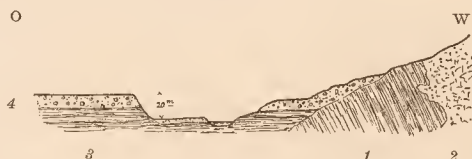
Fig. 130. Flussbett des Wu-liang-ho westlich von Le-tung. 1. Sandstein und Thonschiefer. 2. Granit. 3. Thon. 4. Schotter.
