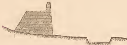
Fig. 84. Querschnitt durch die grosse Mauer in der Nähe von Ping-fan-shien. Massstab = 1 : 200.
