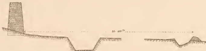
Fig. 85. Profil der grossen Mauer, sowie der vorliegenden Laufgräben in der Nähe von Ping-fan-shien. Massstab = 1 : 200.
