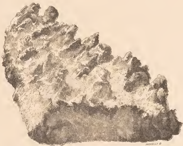
Fig. 43. Ein durch Sandwehen angefressenes Ziegelstück.
