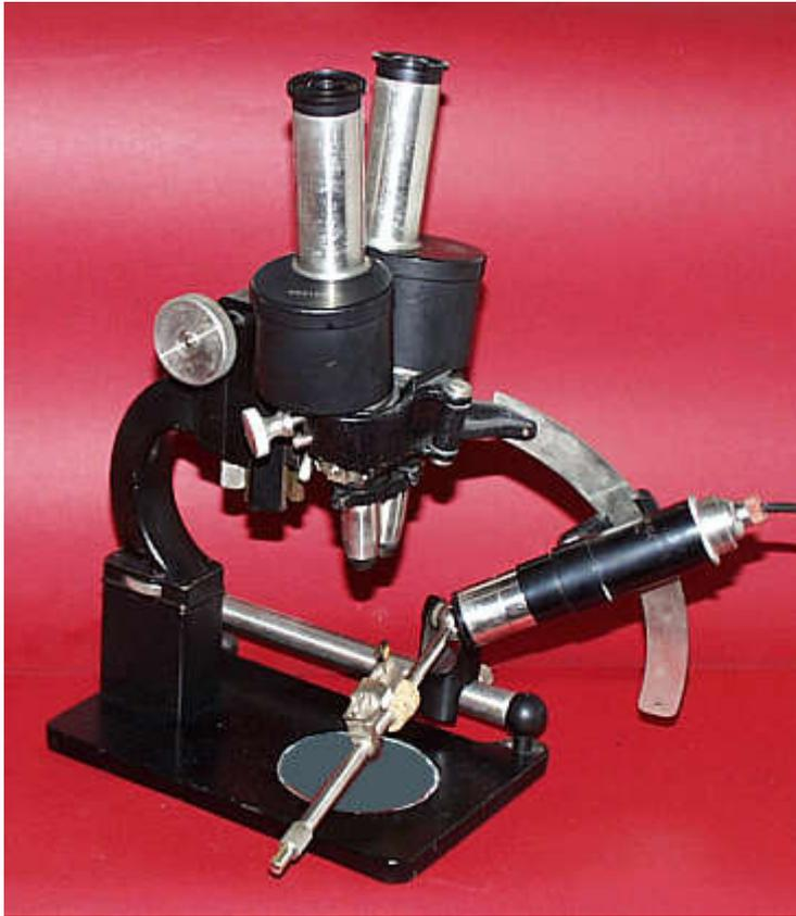
Binokulares Mikroskop von Carl Zeiss, Jena (Nr. 231288) ausgestattet mit Okular-Paaren 4x, 10x und 15x und mit Objektiv-Paaren 4x (Nr. 19203/04) und 6x (Nr. 16493/94). Als Beleuchtung dient eine Auflicht-Lampe mit Optik, deren Stromzuführung in letzter Zeit erneuert wurde. Es ist auch ein Lampensockel zur Verwendung von kleinen Halogenlämpchen dazugefügt worden. Zur Montage von entomologischen Objekten ist ein spezieller Halter für genadelte Insekten mit Korkring vorhanden.
