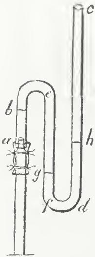
stockes quer abgeschnitten und auf die Schnittfläche desselben eine doppelgebogene Glasröhre, nach der Form beiliegender Figur aufgesetzt; der Verschluss der Röhre mit dem Stamme geschah mittelst Caoutchouc und war vollkommen luftdicht. Die Befestigung dieses Rohres dauerte an 20 Minuten, und während dieser Zeit war der ausfließende Saft in die aufgesetzten Glasröhre um 5 Zoll gestiegen, etwa bis zu dem Punkte, welchen wir mit b bezeichnet haben. Hierauf wurde Quecksilber in den großen
