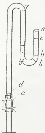
gesetzt, in der Art, wie es die Darstellung zeigt. Die ganze Glasröhre wurde zuerst mit Wasser gefüllt, dann an dem Ende des langen Schenkels mit dem Finger verschlossen; hierauf wurde in den äußeren kurzen Schenkel Quecksilber gegossen, welches das Wasser hinaustrieb und die Röhre bis zu b füllte. Nun ward die Röhre bei a mit dem Finger verschlossen, so dafs aus der Röhre c nichts ausfließen konnte, während dieselbe auf das abgeschnittene Ende des Astes d luftdicht befestigt wurde \*).
