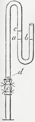
und trockenen Tage Vormittags um  $10\frac{1}{2}$  Uhr als der Versuch angestellt wurde, und die unteren Theile des angeschnittenen Astes waren stark mit Laub bedeckt. Die Glasröhre war mit Luft gefüllt und nur in den beiden äußeren Schenkeln befand sich etwas Wasser, welches bei a und b in gleichem Niveau stand. Schon nach Verlauf von 15 Minuten war zu sehen, daß das Wasser im inneren Schenkel über a hinausstieg; bis gegen Abend 7 Uhr war es um 2 Zoll gehoben worden, und so verblieb
