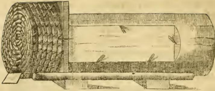
Punkte a) beschriebenes Vereinigungsbret an den Ring gefügt werden, welches in der Mitte die viereckige Durchgangsöffnung besitzt, und die beim Aneinanderstoßen entstehenden Nebenöffnungen verdeckt. Nach dem Abfägen wird hier die Beute der Länge nach auf die Leiter gelegt, so daß der Schnitt das Vermittlungsbret berührt, und dann Alles ordentlich an einander befestiget.
