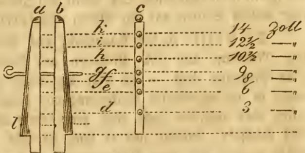
ten oder Vorderseite abgebildet. Jede Säule ist, ohne Zapfen gerechnet, 15 Zoll lang, an dem oberen Ende einen Zoll breit und dick, unten aber einen Zoll dick und zwei Zoll nach hinten breit ; wodurch sich mit dem Zapfen ein rechtwinkliger Absatz gestaltet.
