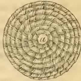
Viertelszoll tief heraus. Auf diese Weise erscheint jetzt der zurückgebliebene Strohspund, resp. Deckel, um einen Viertelszoll schwächer. Er wird dann abgenäht, hierauf rechts und links durch gerades Schneiden losgetrennt, und paßt nun genau in die entstandene Oeffnung. Der Festigkeit wegen gibt man ihm zuletzt aus freier Hand in der Mitte noch eine Naht.
