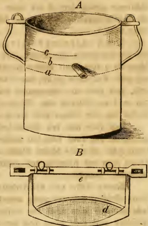
Topfes aufliegt, die dort befindlichen Schlingen gehen. Durch diese Schlingen werden hernach die beiden Riegel geschoben, die gleichfalls am Balken angebracht sind, damit sich beim Kochen der Seiher nicht heben kann. \*)
