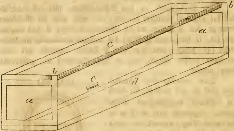
Seitenrahmen wird der Oberrahmen (c) genagelt, welcher mit dem Holze 47 Zoll lang und 12 $\frac{1}{4}$  Zoll breit ist; eben so der Unterrahmen (d) der gleiche Länge, jedoch 14 Zoll Breite besitzt. Das Holz hat die Stärke der Strohbreter, nämlich 1 $\frac{3}{4}$  Zoll.
