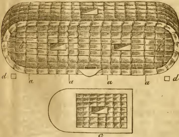
und alle eingeleimt sind. In die langen Seiten kommen beim Einlegen Stäbe; in die Rundungen werden längs der Nähte lange Holznägel
