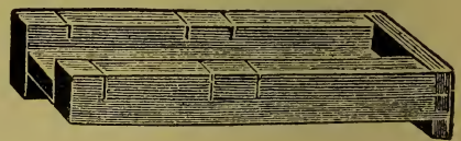
Schneidelade (zu Seite 54—55). Zum genauen Absägen der einzelnen Rähmchenteile.
