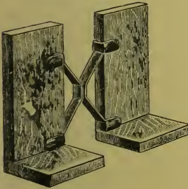
Figur 36 (zu Seite 56). Abstands-Regelungen durch Stifte, Röllchen, Hülsen Bügel und Klappen.]
