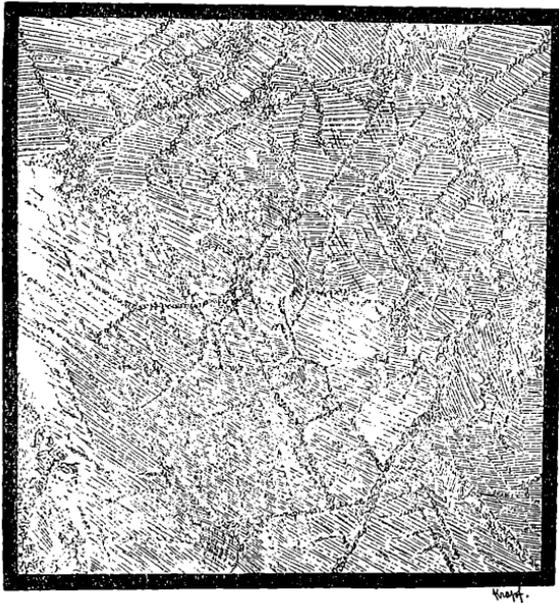
Fig. 112. Dünnschliff in 50facher Vergrösserung. Lochseitenkalk vom Saasberg mit Kataklastenstruktur.
