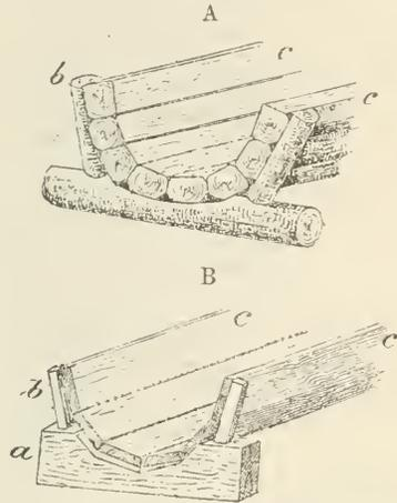
Fig. 903. A Wasserrieße aus behauenen Hölzern, B Wasserrieße aus Bohlen. a Riesenschmel, b Schemelstützen (Doggen), c Riesenpfosten (Läden, Bohlen).
