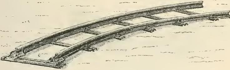
Fig. 864. Gebogenes Geleisstück (5 m lang) mit Stahlschwellen.
