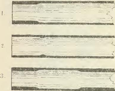
Fig. 953. Längsschnitte verschiedener Würgbohrungen (schematisch dargestellt).
