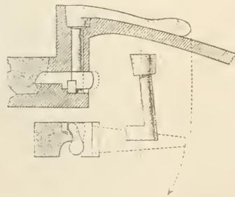
Fig. 845. Scott-Hebel oder Top lever-Verschlusß.
