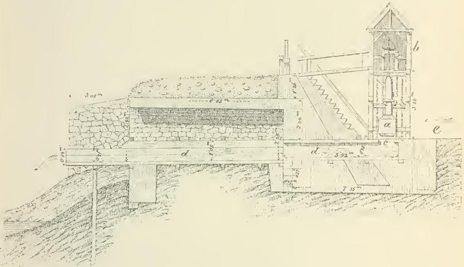
Fig. 960. Zapfenklaufe (im Durchschnitt).
