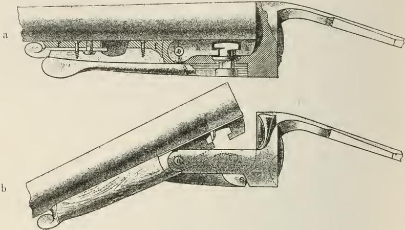
Fig. 840. Lescaux-Verschluss. a geschlossen, b geöffnet.
