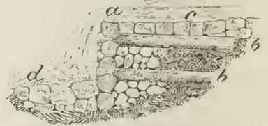
Fig. 906. Ansicht eines Wehres aus Rundhölzern. a Stauwand (Balkenwand), b Längs- hölzer, c Kronenpflaster, d Vorfeldpflaster.
