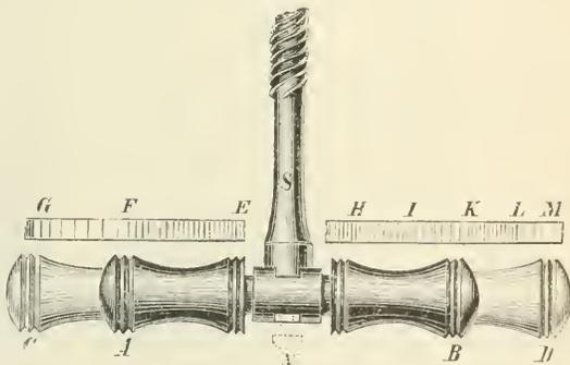
Fig. 986. Zuwachsbohrer.
