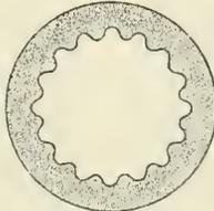
Fig. 973. Zugconstruction von 16 Zügen mit rundem Profil.
