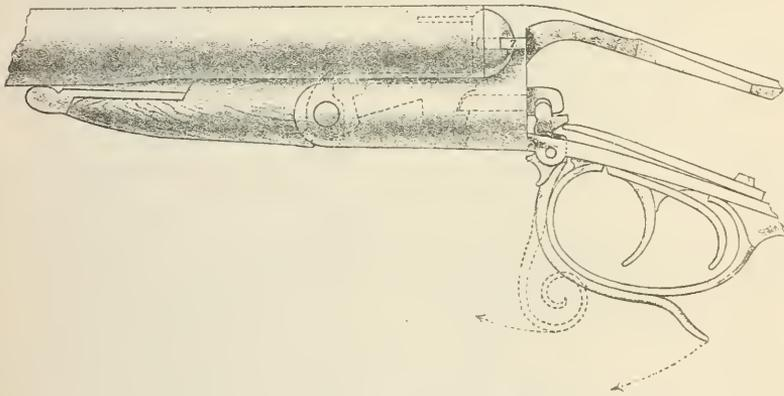
Fig. 844. Schnappschieberverschluss mit Vordendhebel.
