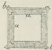
Fig. 901. Querschnitt einer Bohlenpumpe. a Bohlen, b Eisenbänder.
