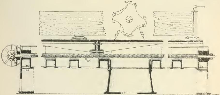
Fig. 225. Abricht-hobelmaschine (Längsschnitt).
