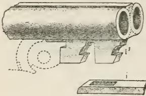
Fig. 846. Laufhaken und Schieber für den zweifachen Verschluss.
