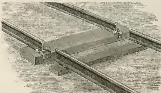
Fig. 872. Stoßverbindung mit eisernen Schienenwinkeln nach Studier.
