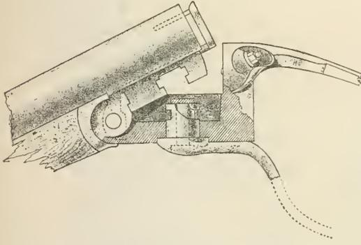
Fig. 843. Verschlusß mit Schraubenwelle, genannt „Systeme anglais“.
