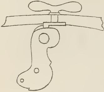
Fig. 849. Flügelgesperr für Schloßler ohne sichtbare Hähne.
