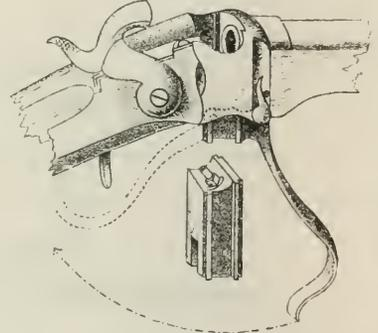
Fig. 838. Verticalblockverchlus, geöffnet.
