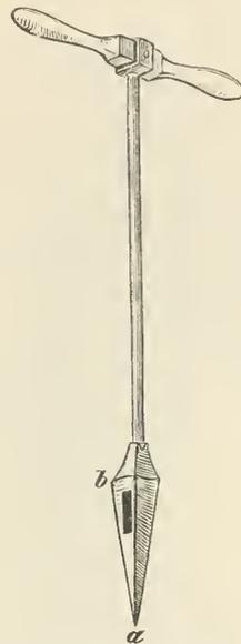
Fig. 899. Wartenberg'sches Pflanzen Eisen.  $\frac{1}{4}$  nat. Größe, 10,5 Pfd. Gewicht. a b eiserner 24 cm langer, zur Verminderung des Gewichtes durchlöcherter Ke gel.
