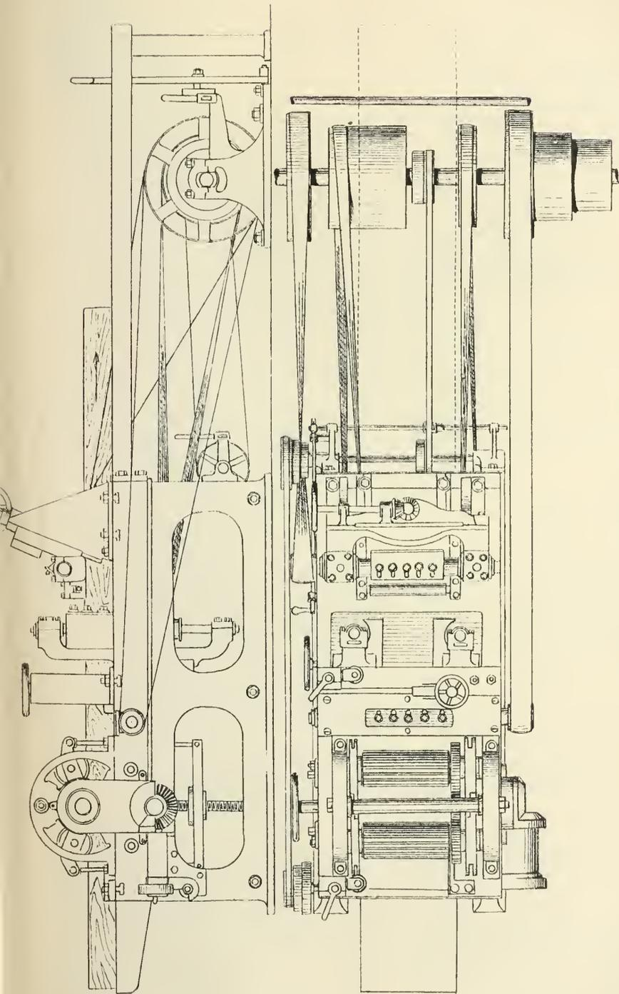
Fig. 3. Vierseitige Hobelmaschine.
