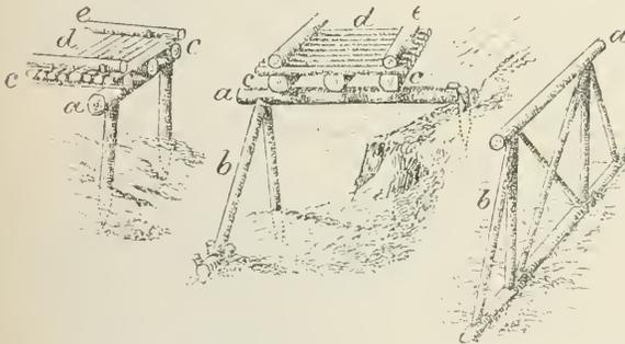
Fig. 894. Construction für einfache Waldwege. a Hochdrehling (Holzholz), b Streben, c Streckbäume, d Fahrbahn mit den Fahrbahnholzern, e Streckbäume.
