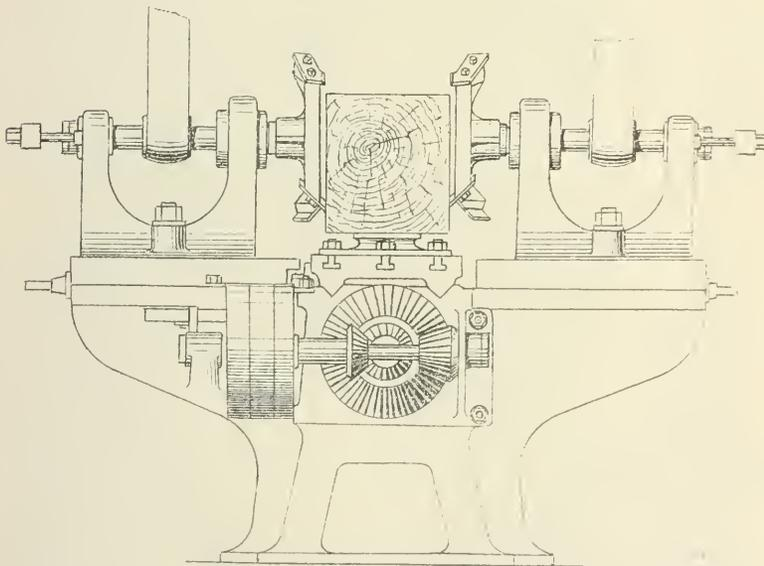
Fig. 226. Abricht-hobelmaschine (vordere Ansicht).
