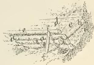
Fig. 896. Ansicht einer hölzernen Verwerkung an einem Waldwege. a Balkenwand, b Querhölzer (Zangen, In-schlösser), c Anschüttung, d Fahrbahn, e Streckbalken, f Strebe.
