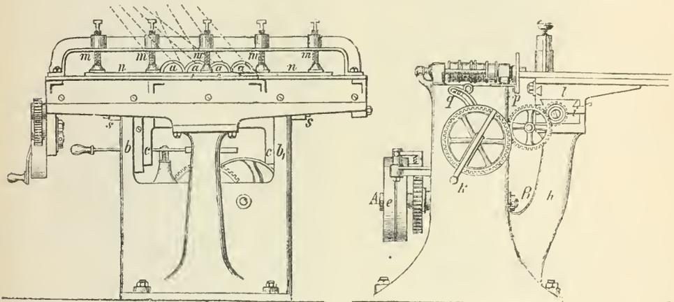
Fig. 931. Zinkenfräsmaschine.
