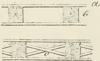
Fig. 987. Einfacher Tramboden. a Fußboden, b Träume, c Kreuzstreben.
