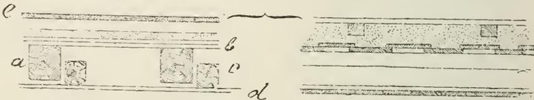
Fig. 988. Sturztramboden. a Träume, b Sturzboden, c Fehlträume, d Plafonderschalung, e Fußboden.
