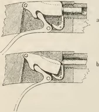
Fig. 837. Halbblockverchlus. a geschlossen, b geöffnet.
