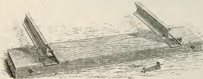
Fig. 871. Dolbergs Normalstoßverbindung.
