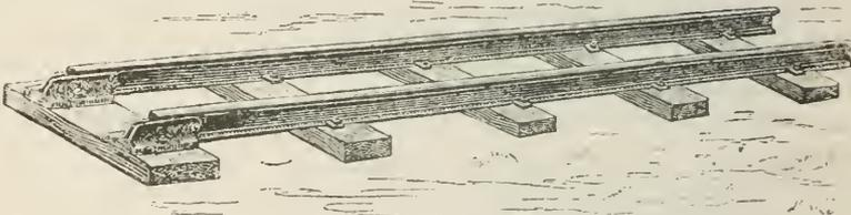
Fig. 863. 5 m langes Geleisstück mit Holzschwellen.
