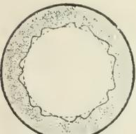
Fig. 978. Polygonalzugsystem nach Henry.
