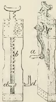
Fig. 915. Ansicht einer Binde. a Kurbel, b Zahn- stange, c Sperrbalken, d Fuß- tage.
