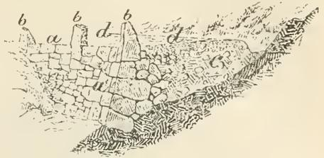
Fig. 895. Ansicht einer Stützmauer mit Abweiskeinen an einem Waldwege. a Stützmauerung, b Abweiskeine, c Anschüttung, d Fahrbahn.
