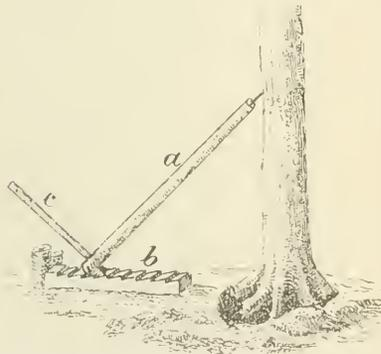
Fig. 953. Baumrodemaschine a Stange, b Zwisch- oder Kerbholz, c Brechstange von Eisen.
