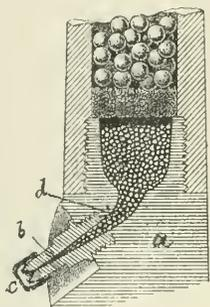
Fig. 982. Zündung mittels Zündcanal. a Kammerstreifen, b Zündstift, c Zündhütchen, d Zündcanal.
