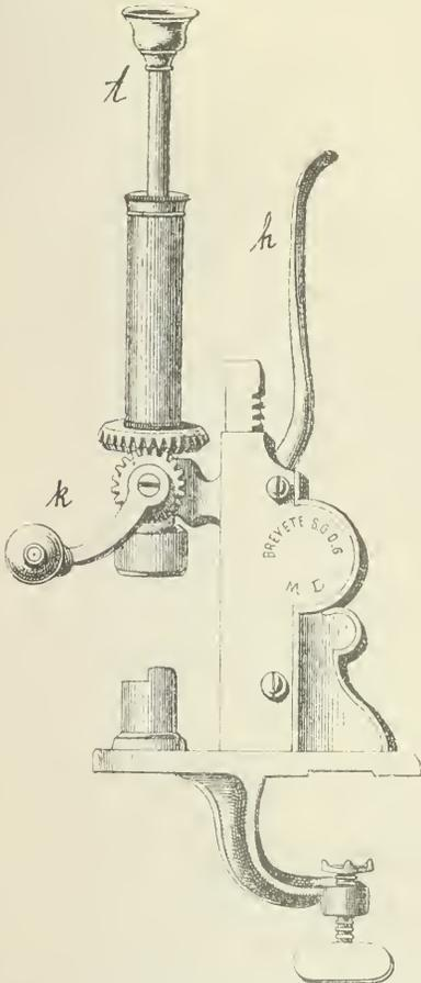
Fig. 957. Würgemaschine mit Labevorrichtung für Sefauchens- und Lancaster-Patronen.
