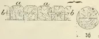
Fig. 990. Querschnitt eines Dippelbodens. a Dippelbäume, b Bolzen von Holz.
