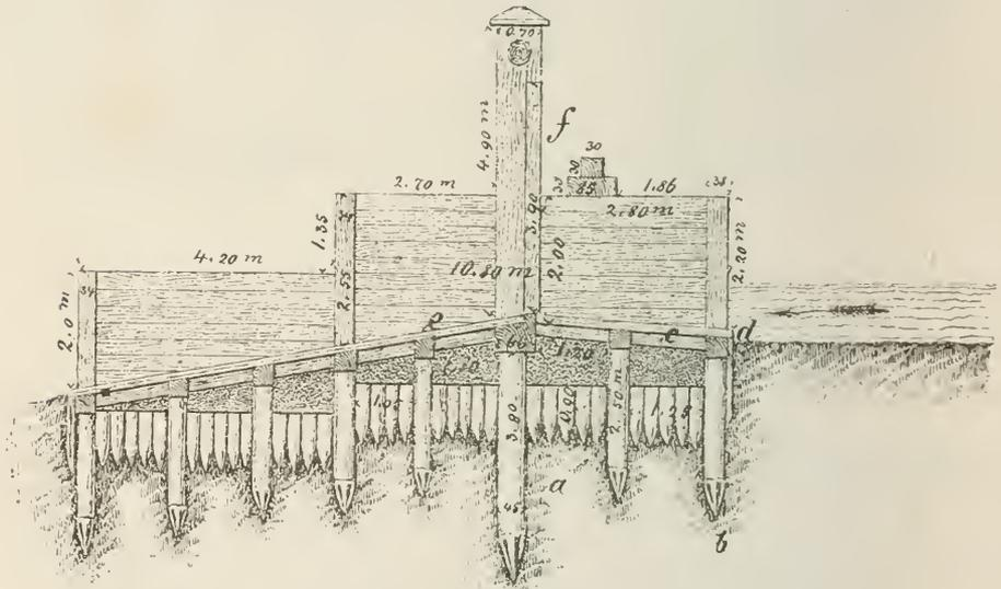
Fig. 910. Querschnitt eines Überfalls- und Schleusenwehres.
