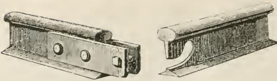
Fig. 868. Stoßverbindung mit Laschen und Schienenanschnitt (System Boos)
